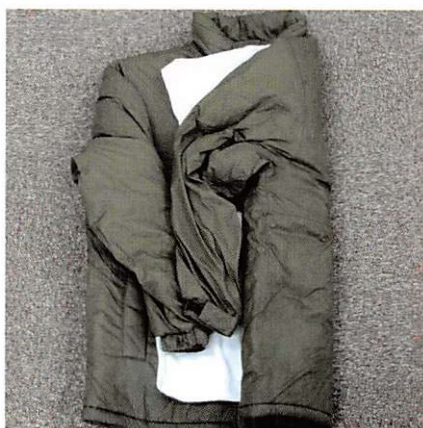
◀タオルをのせた面を内側にして製品をくるみ、一昼夜放置する。
