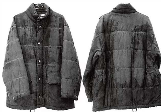
▲ポリウレタン樹脂のシミ出し。 組成表示と、事故部にべとつきが生じていないかを確認する。
