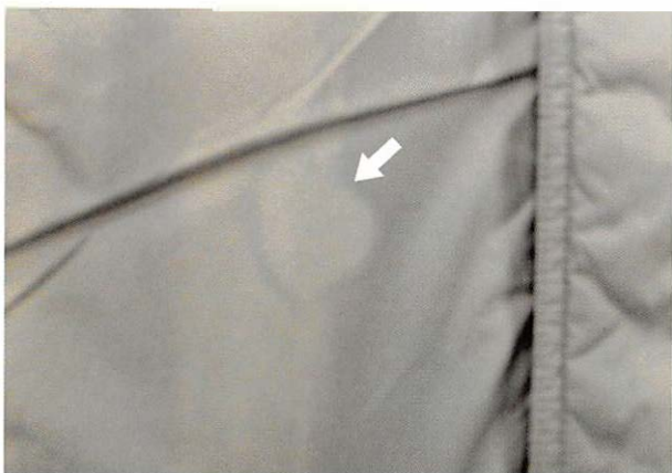
▲滴下した石油系溶剤が乾燥すると、汚れが移動するため輪ジミが生じる。
