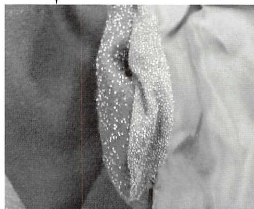
写真中央の左側が表生地のウール、右側が接着芯地。樹脂のポイント数が多いことがわかる。
