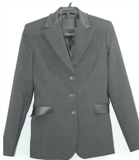
▲ 部分使いの合成皮革が塩化ビニル樹脂であったため、石油系ドライクリーニングで可塑剤が溶脱し硬化したもの。
